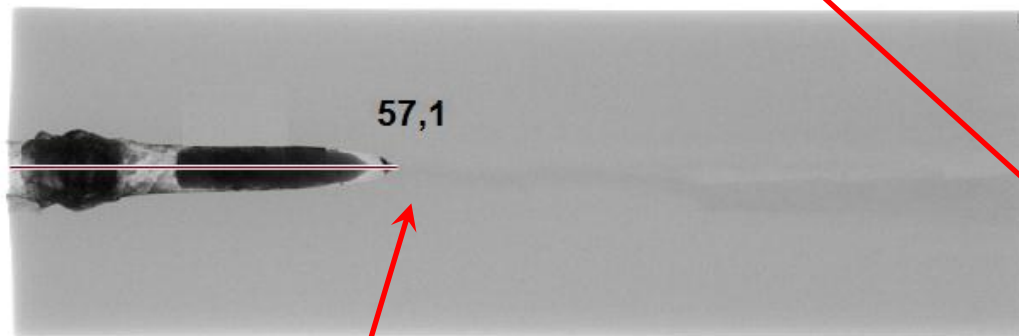
Пуля Б-32 калибра калибра 7,62 мм (термоупрочненный сердчник). Рентген глубины проникновения в Al-плиту толщиной 150мм.
