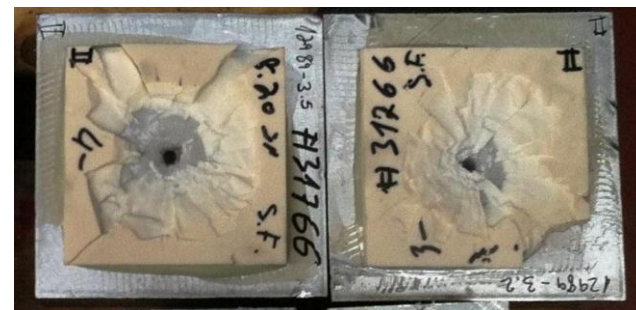
Отечественная пуля БС калибра 7,62мм с сердечником из карбида вольфрама (WC-сердечник).
