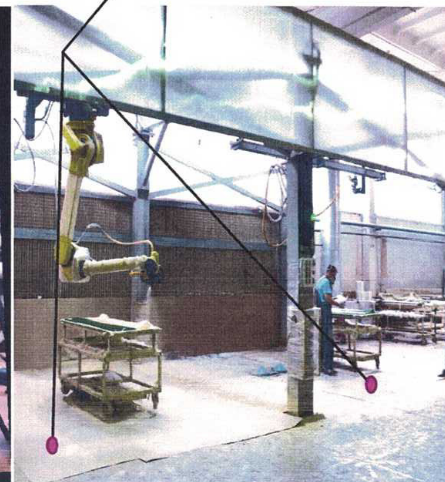
Две рабочие зоны напыления; запатентованная защищенная от загрязнений система позиционирования матриц
